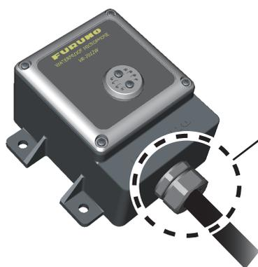
Fixer le presse-étoupe ou le dispositif de verrouillage du câble.
