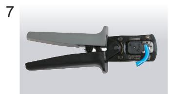
7 À l'aide d'un outil de sertissage spécial MPT5-8 (PANDUIT CORP.), sertir le connecteur modulaire. Enfin, vérifier le connecteur visuellement.
